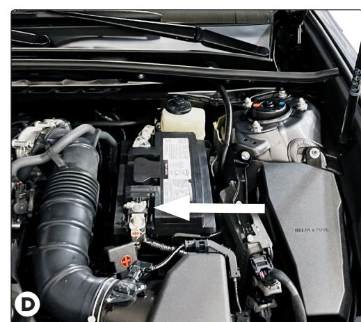
10. Desconecte el cable negativo (-) de la batería del vehículo. Si no se ha retirado, retire el fusible del portador de fusibles amarillo (suministrado). Después de cortar el alambre del portador de fusibles, una el terminal de anillo y asegúrelo al cable positivo (+) de la batería del vehículo. Conecte el otro extremo del portador de fusibles al alambre **negro** de calibre 12 usando el conector de cabeza amarillo (suministrado).
