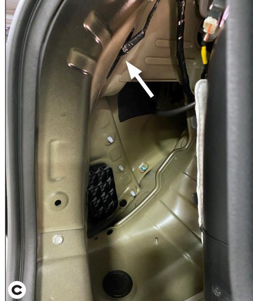
6. Encuentre un punto adecuado de conexión a tierra cerca del conector como es un perno de tierra existente o perfore un orificio de 3/32" y asegure el cable blanco usando el ojete o tornillo que se suministran. (No perforar en el piso o base del vehículo). Limpie la suciedad y el anticorrosivo del área.
