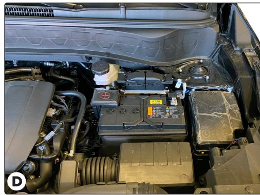
6. Repérer un endroit approprié (p.ex. borne de masse) à proximité du connecteur pour effectuer la mise à la masse, ou percer un trou de 3/32 po et fixer le fil blanc à l'aide de l'oeillet et de la vis fournis. (Ne pas percer le plancher ou la plateforme du véhicule.) Nettoyer la surface pour y enlever toute trace de saleté ou de traitement antirouille.
