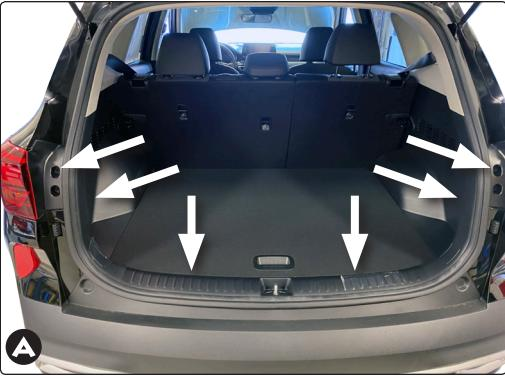
2. Des côtés conducteur et passager, retirer les deux feux arrière à l'aide d'un tournevis étoilé, déconnecter les logements des connecteurs et pousser le câblage du véhicule à travers le trou de passe-fils jusqu' dans le compartiment à bagages. Puis mettre les feux arrière de côté.
