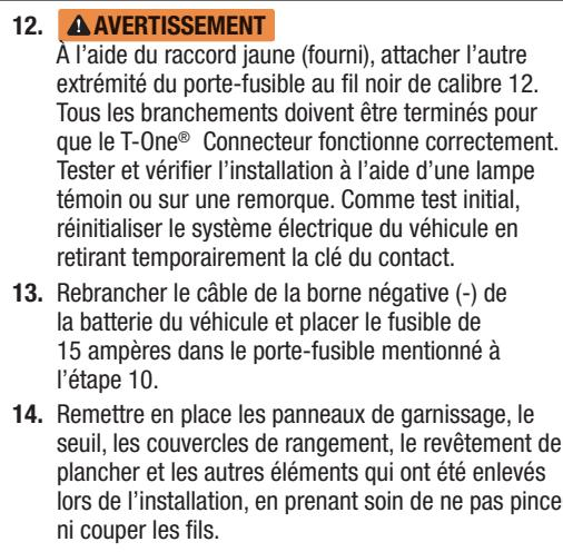
12. **AVERTISSEMENT** À l'aide du raccord jaune (fourni), attacher l'autre extrémité du porte-fusible au fil noir de calibre 12. Tous les branchements doivent être terminés pour que le T-One® Connecteur fonctionne correctement. Tester et vérifier l'installation à l'aide d'une lampe témoin ou sur une remorque. Comme test initial, réinitialiser le système électrique du véhicule en retirant temporairement la clé du contact.
