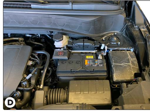
8. En el lado del pasajero, insertar el extremo del conector T-One®, con el cable **verde**, entre los conectores del cableado del vehículo y asegurarlo en su lugar. Tener cuidado de no dañar las lengüetas de bloqueo y asegurarse de que los conectores estén completamente insertados con las lengüetas de bloqueo en su lugar. Empuje la arandela adjunta del conector en T a través del orificio y vuelva a montar la arandela en el orificio.
