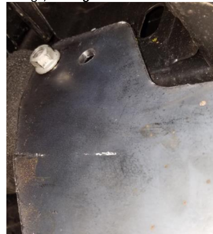
Écrou à embase du crochet de remorquage côté conducteur sur le boulon à embase
