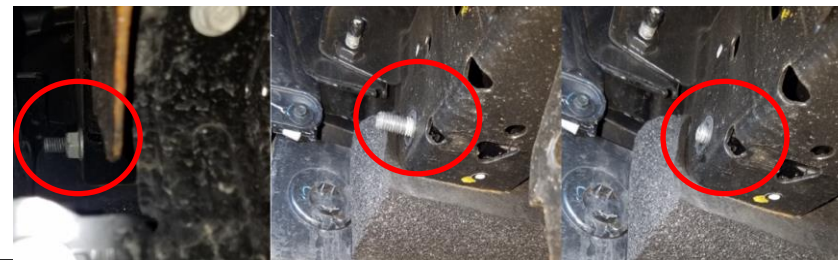
Écrou à embase du crochet de remorquage côté conducteur (Vue à l'extérieur du longeron côté conducteur)
