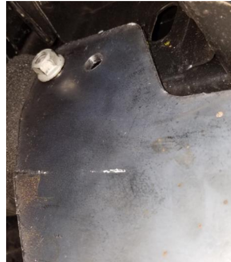
Tuerca de brida del gancho de remolque del lado del conductor en el perno de brida
