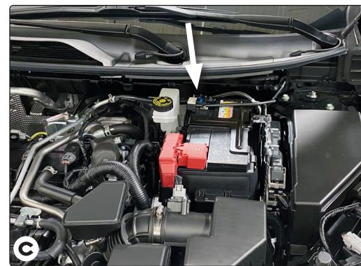
7. En el lado del pasajero, inserte el extremo del conector T-One®, con el cable **amarillo**, entre los conectores del cableado del vehículo y asegúrelo en su lugar. Tenga cuidado de no dañar las lengüetas de bloqueo y asegúrese de que los conectores estén completamente insertados con las lengüetas de bloqueo en su lugar. **C**
