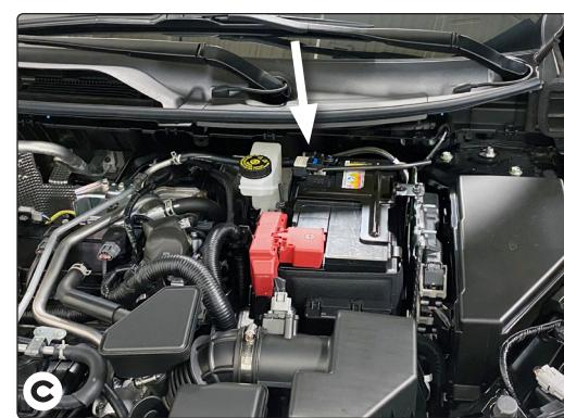
7. Du côté passager, insérer l'extrémité du connecteur T-One® munie du fil **vert**, entre les connecteurs du câblage du véhicule et verrouiller en place. Veiller à ne pas endommager les languettes de verrouillage et s'assurer que les connecteurs sont insérés à fond avec les languettes de verrouillage en place.
