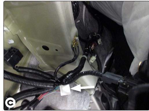
7. Asegure el resto del arnés del conector en T con los amarres del cable que se suministran, para evitar daños y con cuidado de evitar cualquier área que podrían pellizcar, cortar o derretir el cable.
