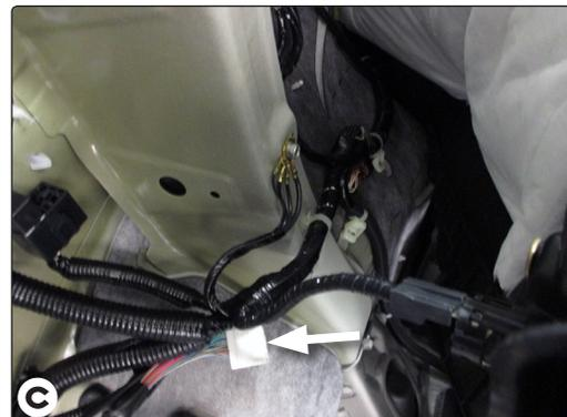
6. Pour prévenir les dommages ou les bruits indésirables, repérer une surface plane à un endroit qui ne gêne pas le passage et monter le module/boîtier noir du T-One® connecteur en T.
