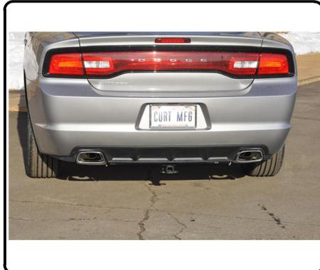
GROSS LOAD CAPACITY WHEN USED AS A WEIGHT CARRYING HITCH: 3,500 LBS. TRAILER WEIGHT & 350 LBS. TONGUE WEIGHT.
